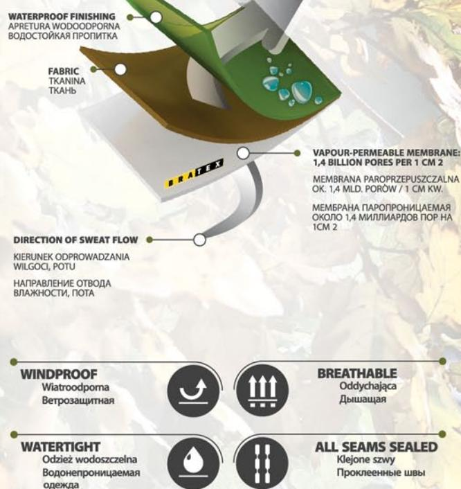
Oдеждь odszyta w systemie WATER STOP dzięki zastosowaniu specjalnej membrany paroprzepuszczalnej BRATEX jest nieprzewiewana i nieprzemakalna, a jednocześnie oddychająca, co zapewnia komfort w użytkowaniu.
